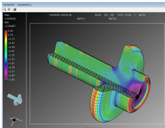
CPM GmbH vertreibt jetzt die **neue Version V 5.4** des bewährten Simulationsprogramms **eesy-2-form** mit integrierter elastischer Analyse des Werkzeugs. Neben der bekannten schnellen, einfachen und genauen Berechnung des Umformvorganges und der Analyse der Werkzeugbelastung enthält diese Version wieder deutliche Verbesserungen in Handhabung und Algorithmen. Das System kann jetzt mehrere Werkzeuge mit unabhängigen Bewegungen handhaben. Besonders zu erwähnen ist die Schnittstelle zu eesy-DieOpt.
