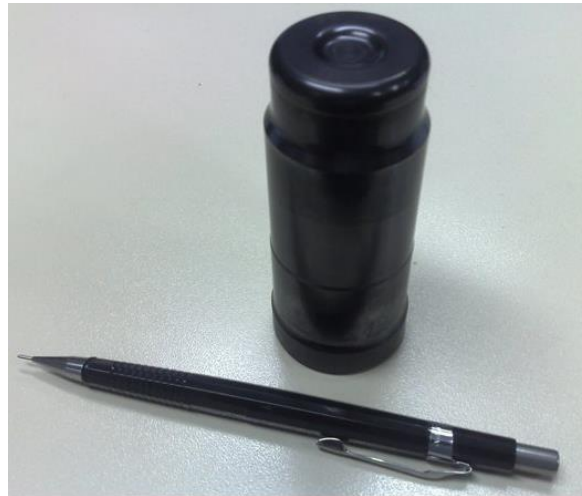
Fig. 4- Punção em M2 + coating em TiAlN
